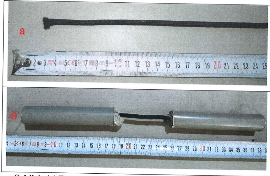
Şekil 1. (a) Deney numunesi, (b) epoksi başlık yapılmış numune
